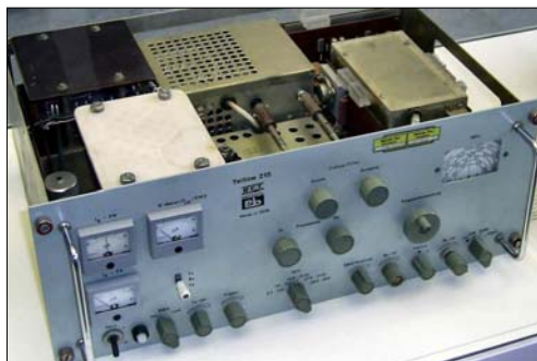
Der KW-Transceiver Teltow-215, das letzte Modell der Reihe, Standardausstattung der Kollektivstationen [1]
