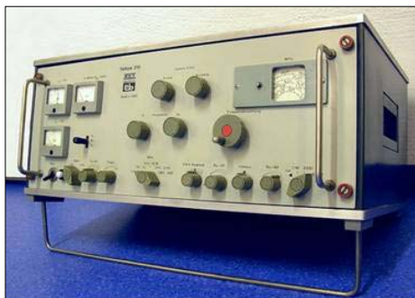
Der KW-Transceiver Teltow-215, das letzte Modell der Reihe, Standardausstattung der Kollektivstationen [1]
